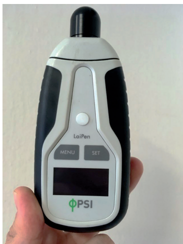
Obr. 1: Přístroj LaiPen LP 110 použitý pro stanovení LAI v porostech přípravných dřevin s dominantním zastoupením břízy Fig. 1: LaiPen LP 110 device used to estimate LAI of pioneer tree stands with the prevailing representation of silver birch
