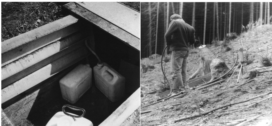
Obr. 1: Detail sondy k měření povrchového a mělce podpovrchového odtoku na dolní straně odtokové mikroplochy a provádění zadešťovacího experimentu.
