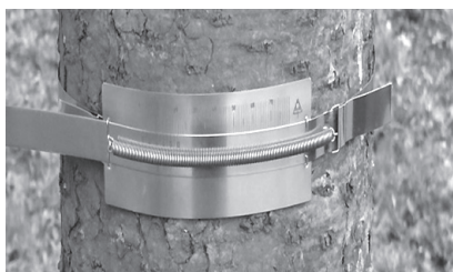
Obr. 3: Mechanický přírůstoměr DB 20 (zdroj: EMS Brno)
