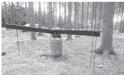
Obr. 4: Podkorunový srážkoměr Fig. 4: Throughfall rain gauge.
