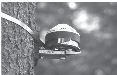
Obr. 2: Automatický přírůstoměr DRL 26 Fig. 2: Stem increment sensor DRL 26
