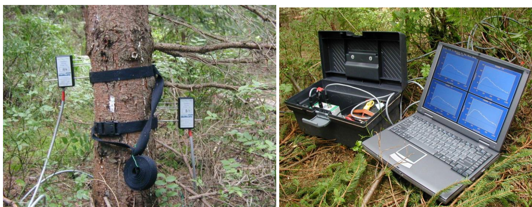
Obr. 6. Systém SF 300 (Greenspan Technology, Austrálie) pro měření rychlosti transpiračního proudu sestávající z páru sond zavrtaných přímo do kmene (vlevo) a datalogeru umožňujícím automatické měření a komunikaci s PC (vpravo).
