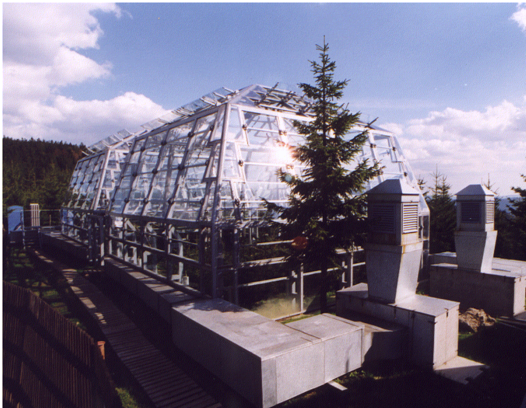
Obr. 3. Kultivační lamelové sféry pro simulaci účinku zvýšené vzdušné koncentrace \text{CO}_2 na vybrané druhy lesních dřevin a trav umístěné na EEP Bílý Kříž v Moravsko-Slezských Beskydech. Rozměry jednoho „skleníku“ jsou 9 m x 9 m x 7 m (podrobný popis viz Urban a kol. 2001).
